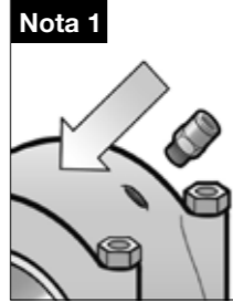
Nota 1 Instale 084349, un adaptador para el tubo tipo encaje a presión, directamente en el punto de lubricación.
